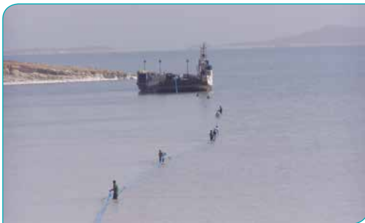
شکل ۱-۱۱- انتقال آب با شناور به منبع ذخیره آب در جزیره اشک (عکس از حجت جباری)
