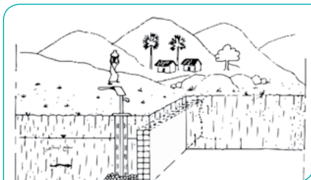
شکل ۲-۷- نمای کلی سد زیرزمینی
