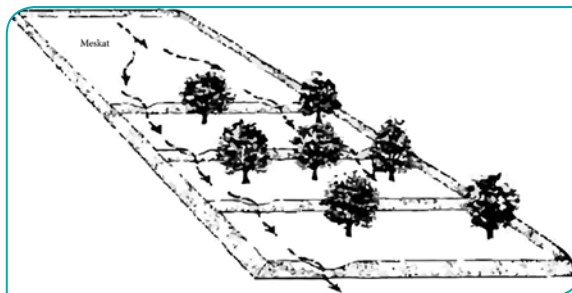
شکل ۲-۶- نمایی شماتیک از روش پخش سیلاب با استفاده از کرت‌بندی زمین
