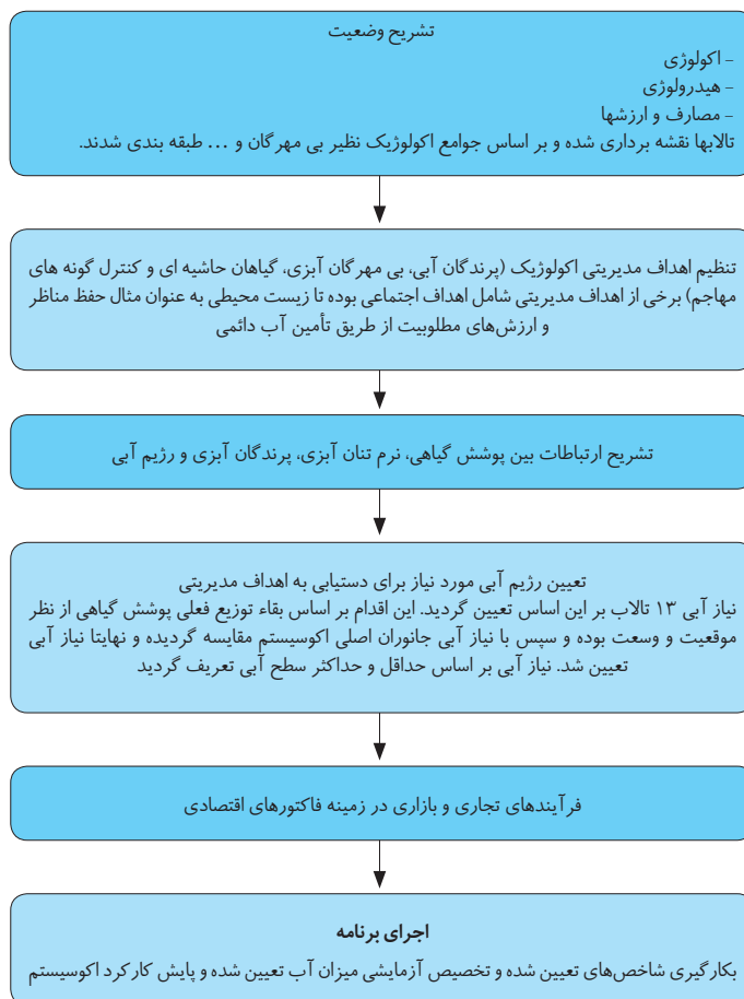
شکل ۱۱-۱: نمودار فرآیند تعیین نیاز آبی وابسته به پوشش گیاهی، بی مهرگان و پرندگان
